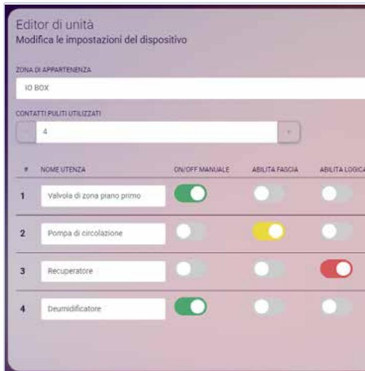
La programmazione delle fasce orarie associate ad un singolo dispositivo è effettuata mediante il calendario settimanale posto al di sotto dell'editor. Il calendario è settimanale e di concezione analoga alla programmazione dello stato di accensione dei ventilconvettori.
